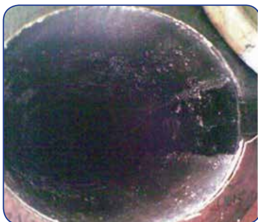
وضعیت فولینگ بعد و قبل از استفاده از هگزان ضایعاتی در راکتور
